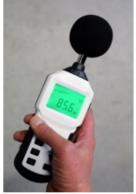
Fig. 34. Ejemplo de dispositivos que permiten la medición del ruido
