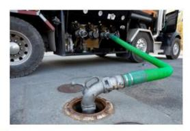
Fig. 41. Proceso de rellenado del tanque de una estación de servicio
