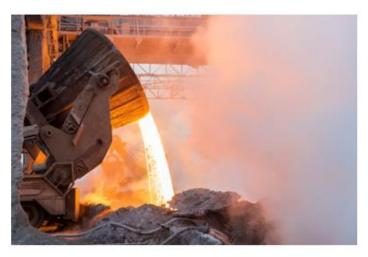
Fig. 51. Gases producidos durante el proceso de fundición del metal
